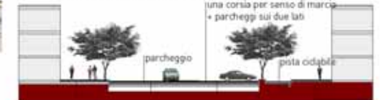
sezione B - strada interna verso asse nord-sud
