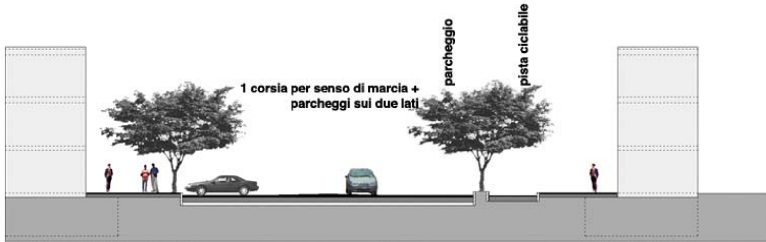
sezione cc_strada interna verso asse nord sud
